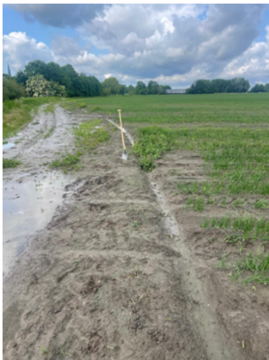
Figuur 13. De proefopstelling tijdens inspectie op 6 juni 2025. De buis die het water naar de debietmeter voert ligt op het laagste punt, te zien bij het gele bordje aan het einde van de greppel.
