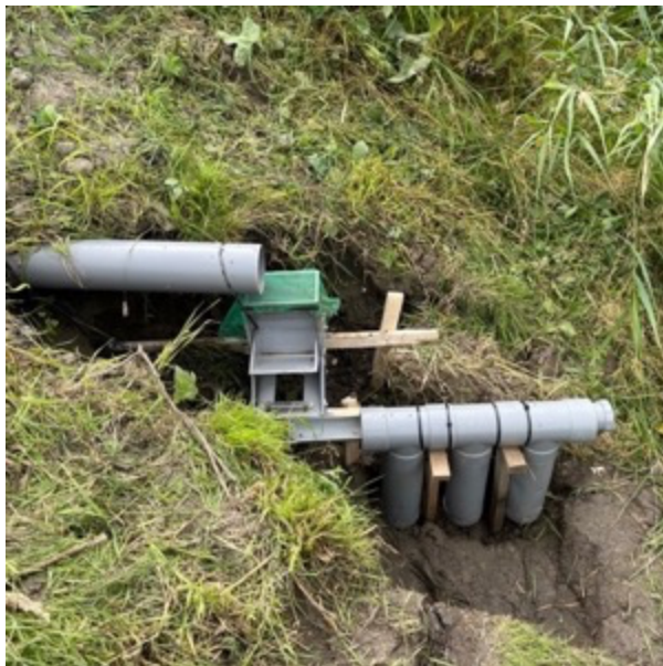
Figuur 2 links: debietmeter en het wateropvangsysteem met 3 flessen (2024); Rechts: debietmeter en wateropvangsysteem met één fles (2025).
