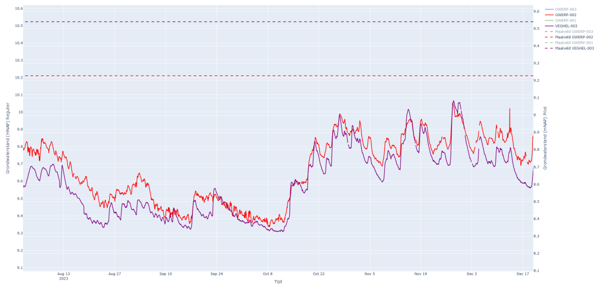
Figuur 31. Verloop grondwaterstanden regulier en pilotlocatie (GWERP-002 en VEGHEL-003)
