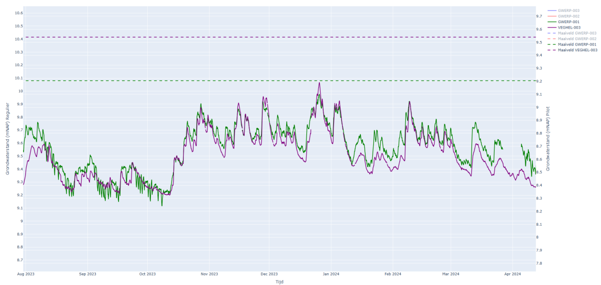
Figuur 30. Verloop grondwaterstanden regulier en pilotlocatie (GWERP-001 en VEGHEL-003)
