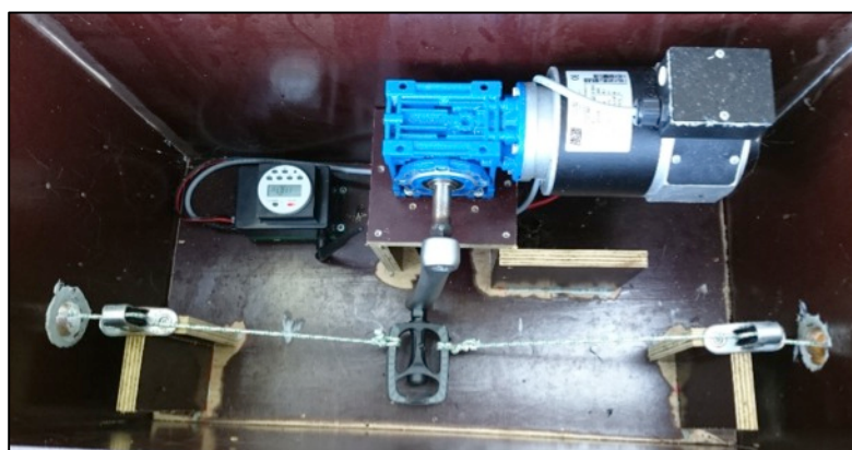
Foto 1. Aandrijfsysteem van de krekel. Linksboven is de tijds klok met zender te zien. Deze activeert de motor (rechtsboven). Aan de toerenreductiekast (blauw) zit de trapas en trapper verbonden. Aan de trapper zitten de touwen verbonden die de krekels aandrijven. Foto: J.Snijders.
