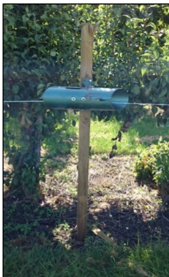
Foto 2. Krekel aan houten paal. Links zit de aandrijfkast, rechts het elastiek. Foto: J. Snijders
