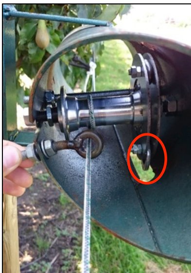
Foto 3. As midden in krekkel met daaraan de naaf met drie schakels (één schakel rood omcirkeld). Deze wordt aangedreven via een touw door de motor. Achteraan zit het draadeind waar de schakels tegen slaan. Foto: J. Snijders
