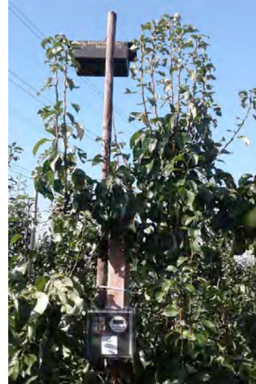
Afbeelding 2.2. De opstelling van de Alcetsound zoals die in het proefperceel staat. Bovenaan hangt een van de twee geluidsboxen en onderaan hangt de versterker/besturingsunit.
