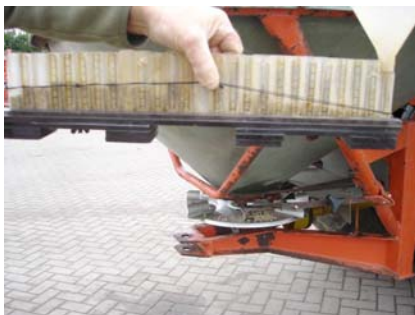
foto: verdeling van de kunstmeststrooier is slecht: links is meer kunstmest gestrooid dan rechts
